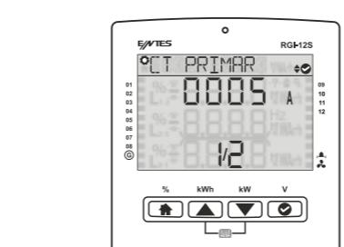
Geben Sie die Sekundärwert des Stromwandlers ein und drücken Sie OK.
