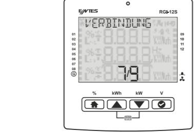
Das OK-Symbol leuchtet in der oberen rechten Ecke des Bildschirms auf. Sie können die Auf- und Ab-Tasten verwenden, um zwischen Hauptmenüs und Untermenüs zu wechseln. Drücken Sie OK.
