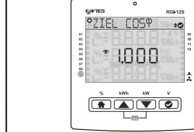
Geben Sie den Referenzstufe ein und drücken Sie OK. (Der Referenzstufe muss ein 3-Phasen-Kondensator sein.)
