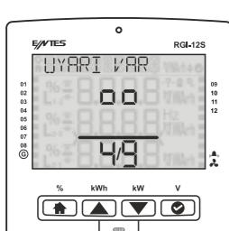
Cihazınızın bildirim ledi Kırmızı renk yanar. Cihaz bildirim modunun Kırmızı renk olması anlam sisteminize ilişkin bir alarm durumu olduğunu bildirir. Cihazınızın herhangi bir tuşuna bastığınızda cihaz üzerinde olmuş alarmları görebilirsiniz. OK tuşuna bastığınızda ekranда görülen alarmı erteleyebilirsiniz. OK tuşuna basınız.
