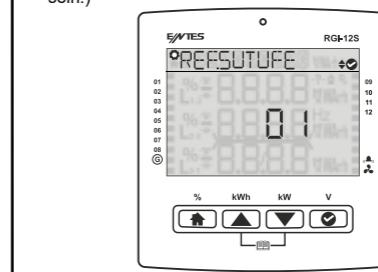
Automatische Stufenerkennung wird gestartet, bitte warten Sie.
