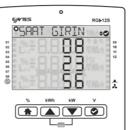
Cihazınızın bildirim ledi Mavi renk yanar ve cihazınızın Jeneratör modunun aktif olduğunu gösterir. Cihazınız Jeneratör ayarlarında bulunan girmiş olduğunuz değerler doğrultusunda çalışır. OK tuşuna basınız.
