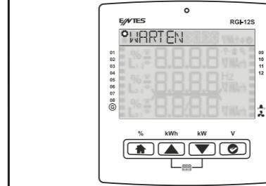
Die Phasenfolgeoperation ist fertig. Drücken Sie OK. Enter the reference step and press OK.
