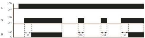
U : Supply Voltage S : Start Input R : R1 Relay td : Delay Time
